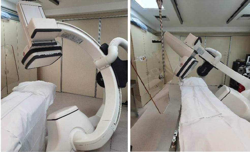
Figura 2. Equipo de rayos X. Arco en C, en este caso con apoyo en el piso. Móvil. En el extremo superior del arco puede verse el intensificador de imágenes tipo “flat” y en el extremo inferior, el tubo de rayos X.
